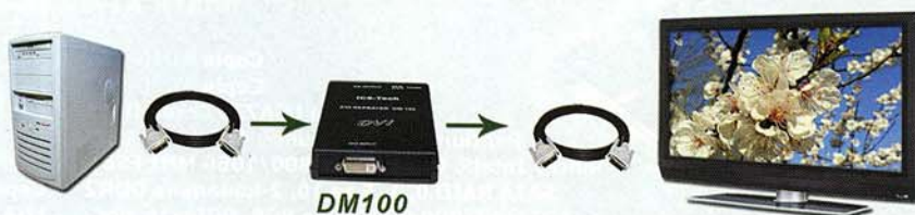
Рис. 1. Передача DVI-сигнала с использованием повторителя DM100
