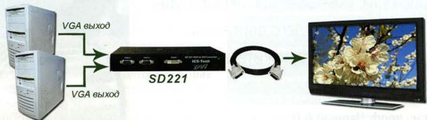
Рис. 4. Применение преобразователя VGA-DVI SD221
