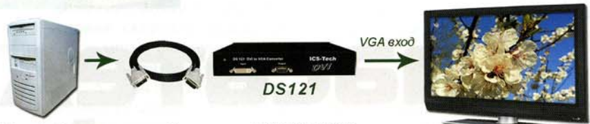
Рис. 5. Применение преобразователя DVI-VGA DS121
