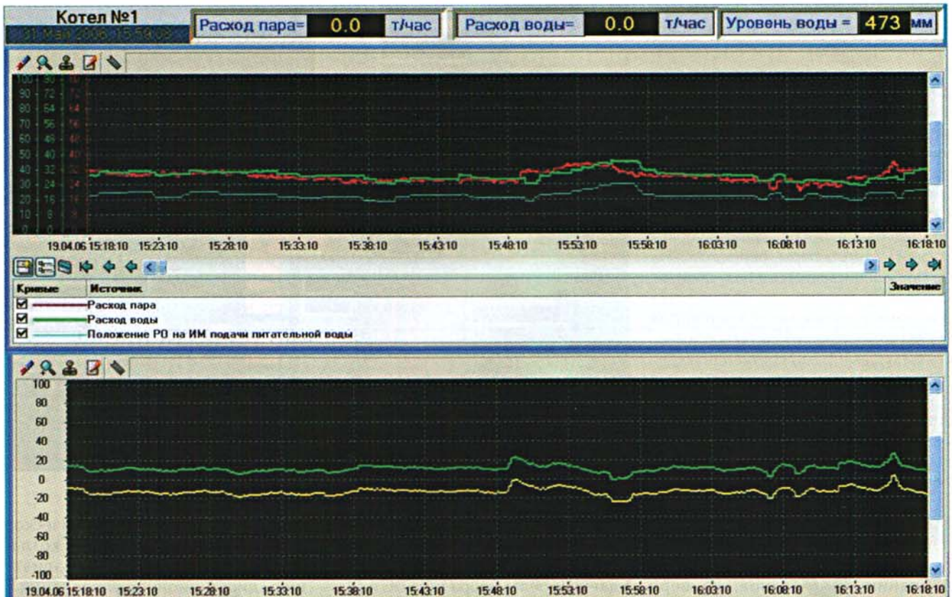
Рис. 3. Технологическая информация, отражающая все основные параметры работы и потребления ресурсов ТЭЦ, передается на АРМ оператора, что позволяет осуществлять оперативный контроль за работой станции в реальном времени
