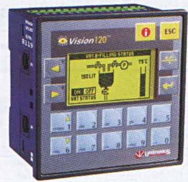
Высокопроизводительный контроллер Vision 120 поддерживает до 24 контуров ПИД-регулирования
